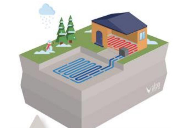
Figure 9 : Schéma de principe du captage horizontal (Source : AFPG)
