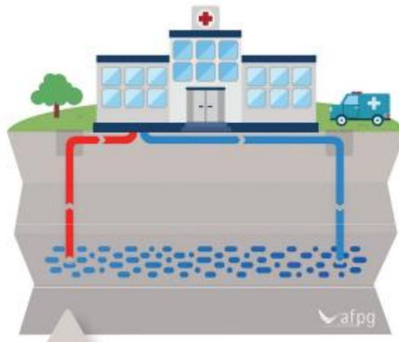
Figure 7 : Schéma de principe du captage sur nappe. (Source : AFPG)
