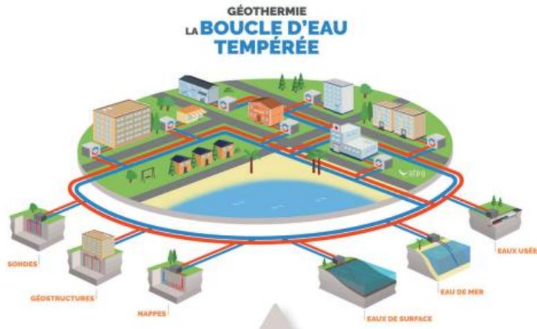
Figure 15 : Principe d'une boucle d'eau tempérée géothermique
